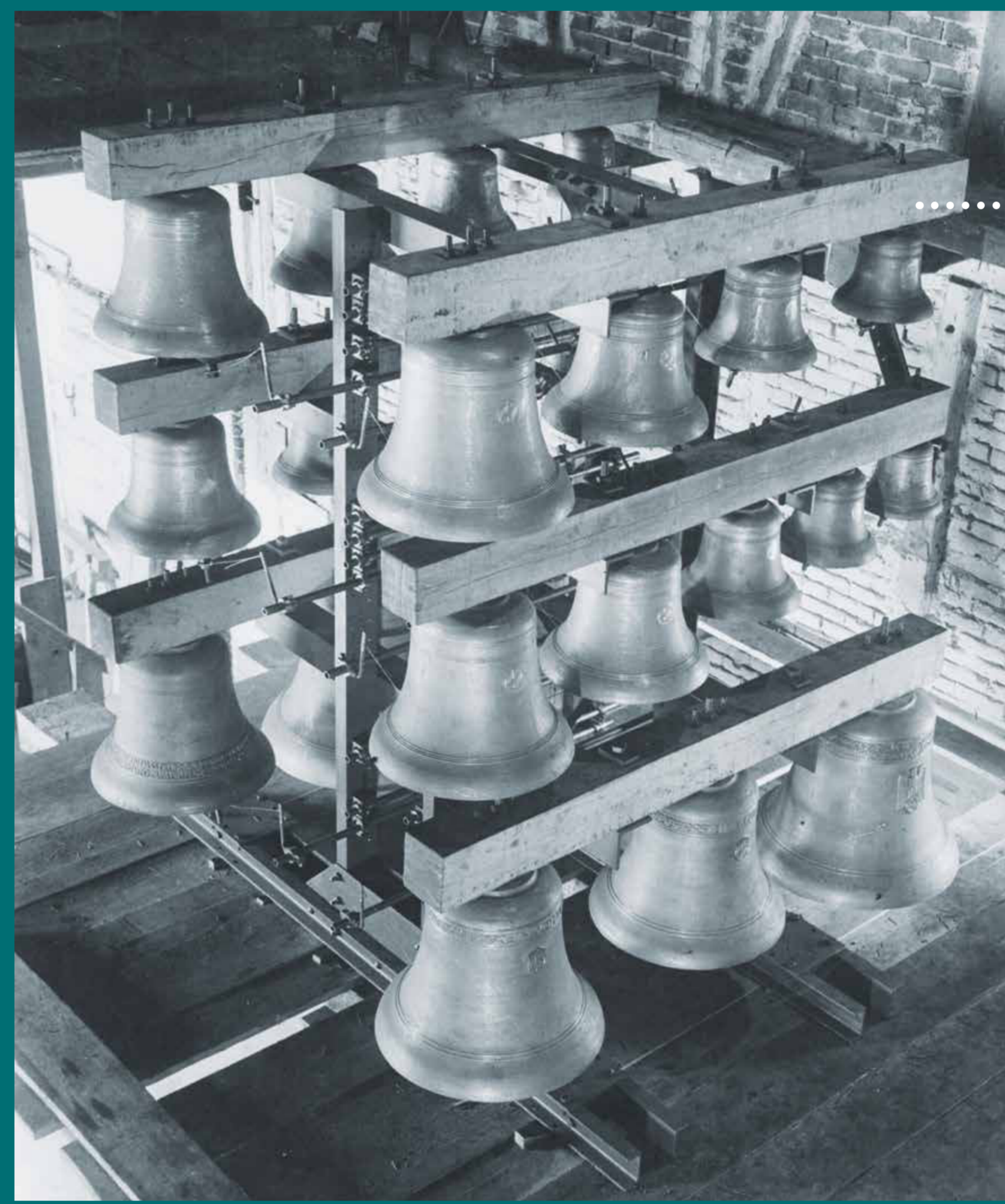
Probeaufbau des Glockenspiels in der Hofglockengießerei Franz Schilling Söhne (Apolda)
